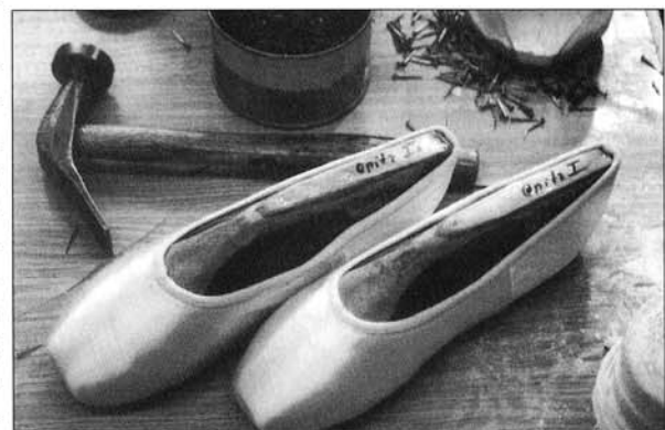
Abbildung 4: Der fertige Schuh über dem Leisten
